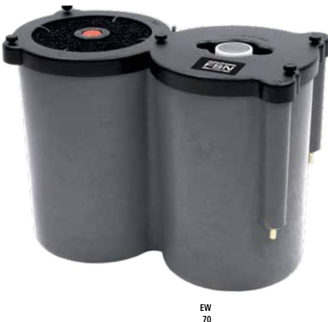
Os separadores EcoWater, com uma configuração de duas torres multi-fase, são constituídos por um elemento em fibra de polipropileno e um elemento em carbono ativo, especialmente selecionados e tratados para maximizar as propriedades de absorção, permitindo a máxima eficiência de filtragem.
